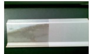
Recuperación de perfiles por defectos de "manchas de agua"
