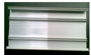
Recuperación de perfiles por defectos de "rayas de matriz"
